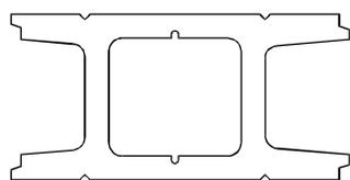
Bloc pour 1/2 module et à oreilles détachables pour réaliser les angles
