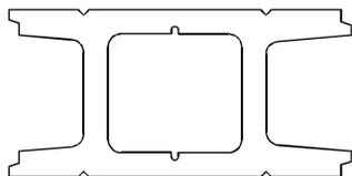
Bloc pour 1/2 module et à oreilles détachables pour réaliser les angles
