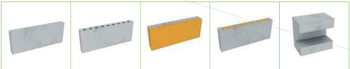
Les planelles peuvent être posées à joints épais sur blocs à voile de pose ou posées à joints minces sur blocs à alvéoles débouchantes. Il convient de respecter les conditions de pose des fabricants.
