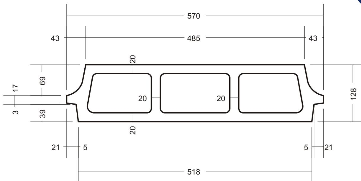
Élément de coffrage, utilisé pour la construction de planchers en béton.
