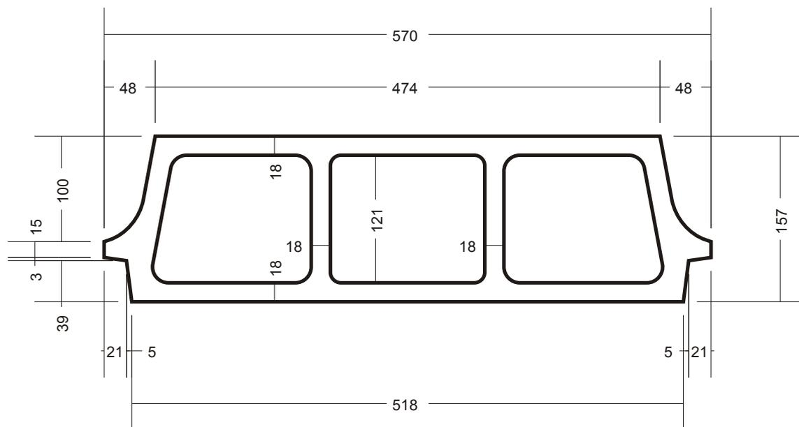
Élément de coffrage, utilisé pour la construction de planchers en béton.
