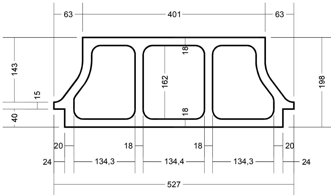
Élément de coffrage, utilisé pour la construction de planchers en béton.
