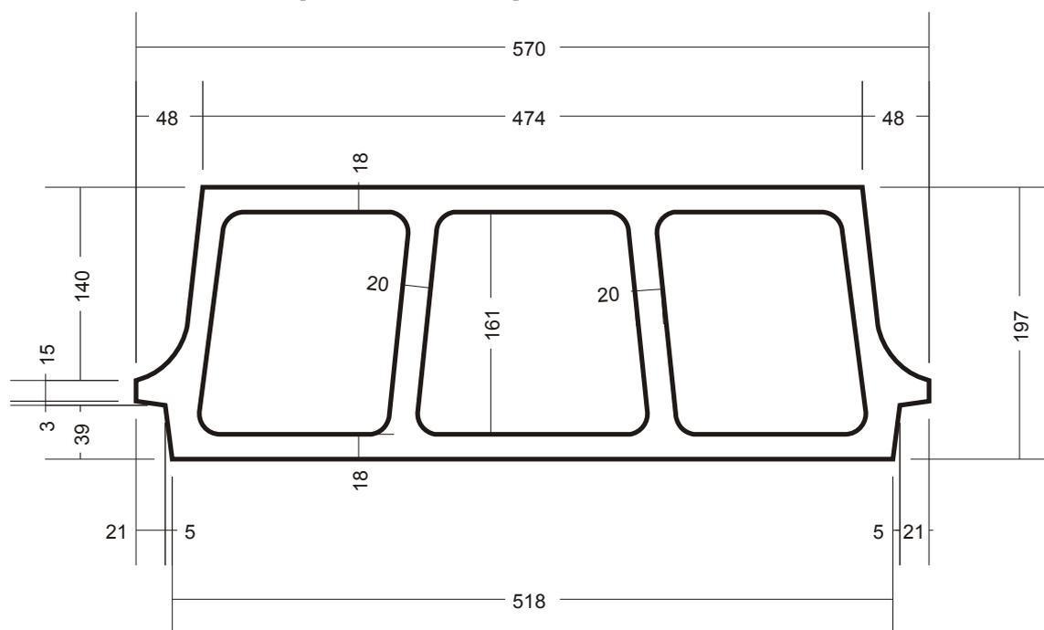
Élément de coffrage, utilisé pour la construction de planchers en béton.
