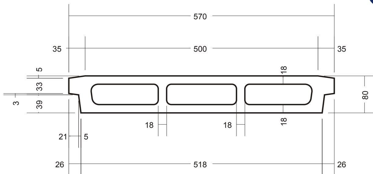
Élément de coffrage, utilisé pour la construction de planchers en béton.
