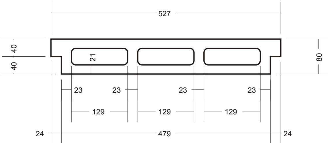
Élément de coffrage, utilisé pour la construction de planchers en béton.
